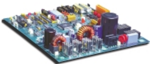
Tarjeta Electrónica del Módulo de Control y Protección (CAPM)
